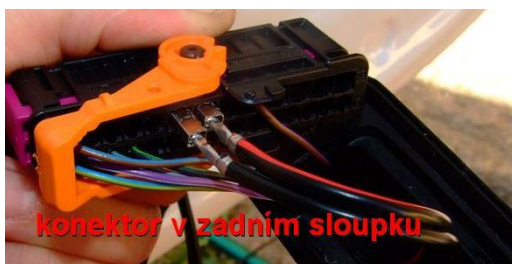
Obr.5 Osazení vodičů do konektoru ve sloupku B
