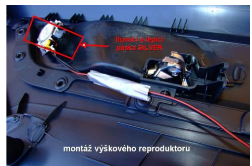
Obr. 4 Umístění výškového repro
